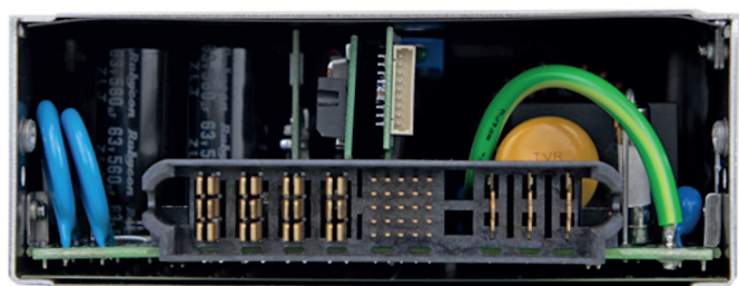
Systémový konektor umožňujúci hot-plug funkciu
