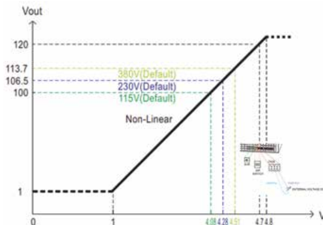
Obr. 2: Priebeh nastavenia napätia zdroja série RST-15K-HV
