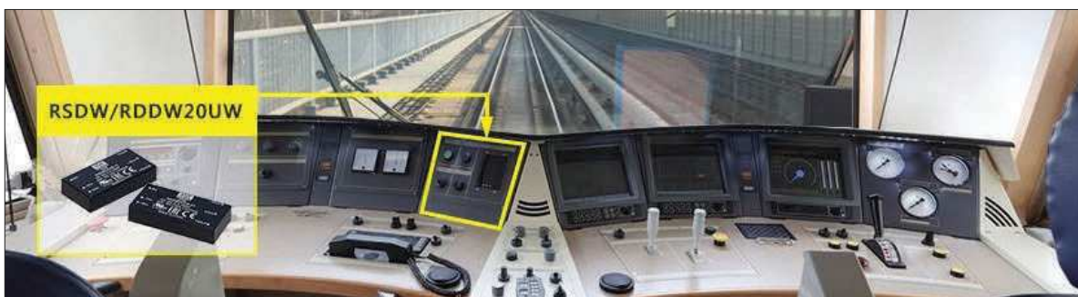
Obr. 2. Příklad použití DC-DC měničů s širokým rozsahem vstupu
