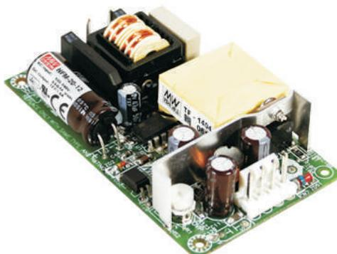
Obr. 6 Zdroj Mean Well typu medical NFM-20
